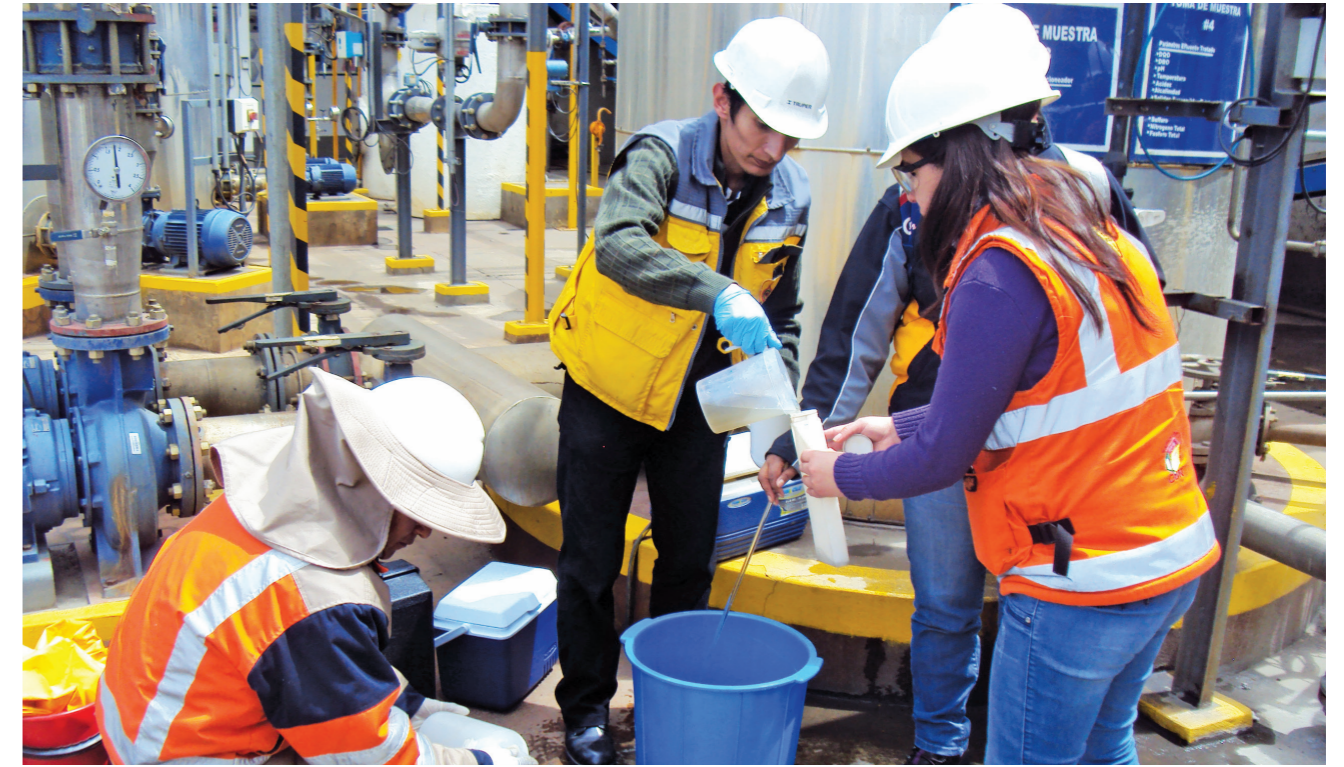
Fotografía: Monitoreo las descargas líquidas industriales, Fuente: Archivo GAMLP, 2018
